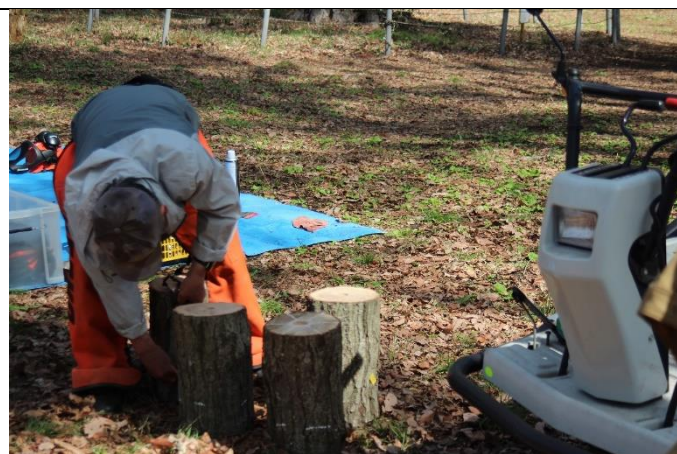
チョークで縦挽き深さの目印を付ける
