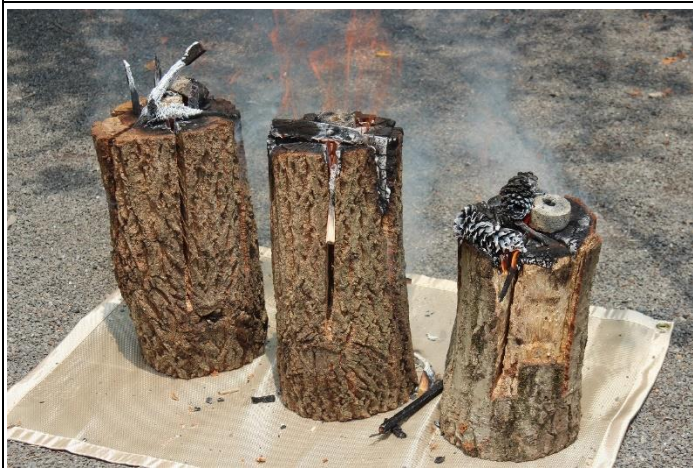
長さや径に寄らず、どの材も良く燃焼した
